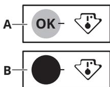
Toidu õigeks säilitamiseks on külmik varustatud temperatuuri indikaatoriga. Seadme külgeinal asuv sümbol osutab külmiku kõige külmemale alale.
