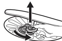
Za skidanje filtara (B) okrenite ručicu (C) u smjeru suprotnom od smjera kazaljke na satu i povucite prema gore. Izvadite filter (C) iz filtra (B).
