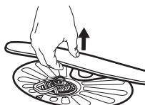
Для извлечения нижнего разбрзывателя потяните его движением вверх.
